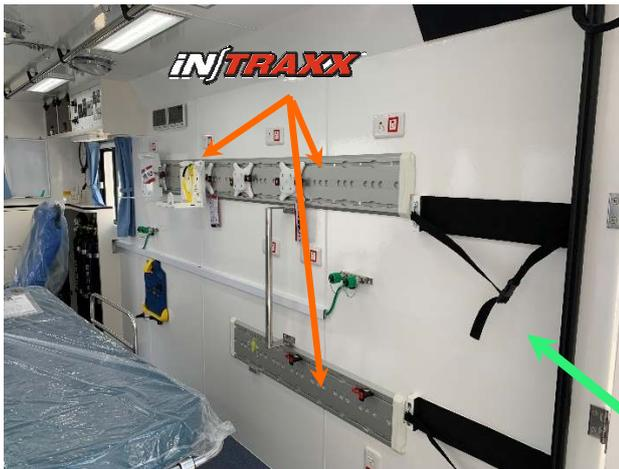
ECMO搬送以外も考慮し、患者室内の右側面にはiNTRAXXレールを過去最多の3本設置しています。今回は呼吸器と除細動器の設置が出来るように金具を設置してあります。
