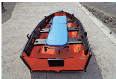
座席シートへの滑り止め加工により、安定して担架やストレッチャーを乗せたまま運搬できます。
