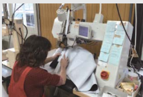
シーリングマシンによる防水加工
