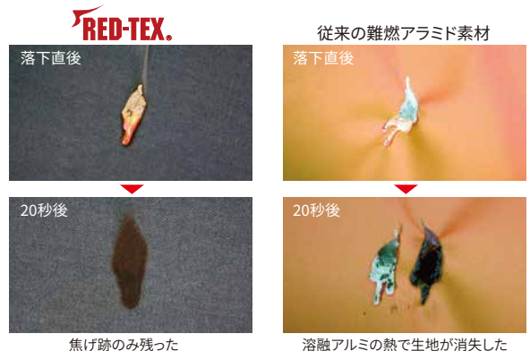
実験③ 溶融したアルミ(約700°C)を生地へ落とす(20秒間放置)
