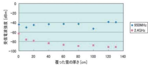
「ヒトココ」の900MHz帯は、雪による電波減衰の影響がほぼ無し。雪前埋没時、積雪時の捜索にも有効。
