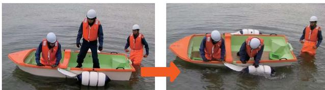
フロートを装着することにより、船体の横揺れや転覆を軽減し、乗船時の片舷への沈み込みを防止するため安全性が向上します。
