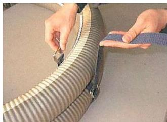
2. ベルトの先端を持ち上げリングを上部へ
