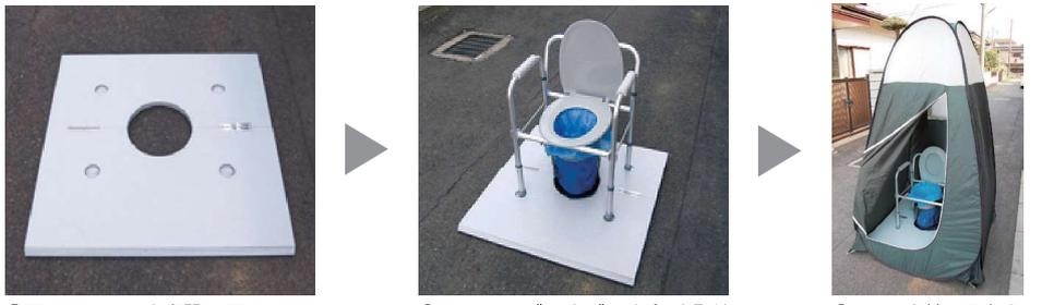
①マンホールのふたを開け、マンホール調整プレートを載せます。 ②マンホールガイド、ガイドポリを取付けたトイレ本体を設置します。 ③テントを被せて完成
