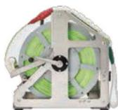
デザーユニット(ケーブル)には3.7mmの光ケーブルを300m格納しています。ユニット自体の重量は12.3kg。ケーブルは約140kgまで加重できるほど頑強です。
