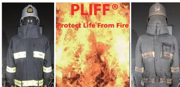
・赤尾製防火服は全て燃焼マネキンシステム「PLIFF<sup>®</sup>」で安全性を検証しています。
