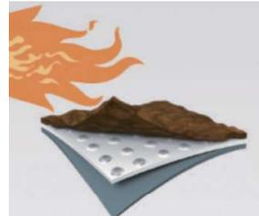
接炎すると着用者を防護する強固な遮熱層を形成します。熱と炎の曝露後もラミネートとシーム部の物理的な強度は曲げたりしても維持されます。
