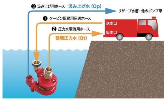
●水カタービンを動力源に水を循環させることにより、大量の水(海水等)を汲み上げる高揚水ポンプです。
