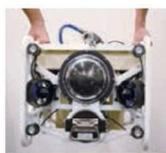
本体重量は約28kg。クレーンなどは必要なく、ボートでも運べます。最少2名で運用できて、すべて人の手で動かせます。
