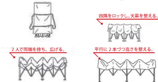
●フレームが一体かつジャバラ式の構造により、少人数で設営設置が短時間で出来ます。また、脚下にはキャスターがついていますので、移動・運搬が容易に行えます。
