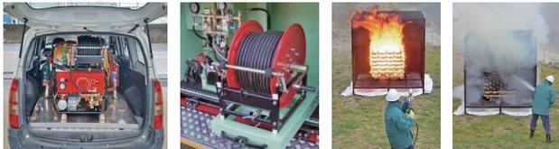
エンジンセット車両積載例 車両PTO式
