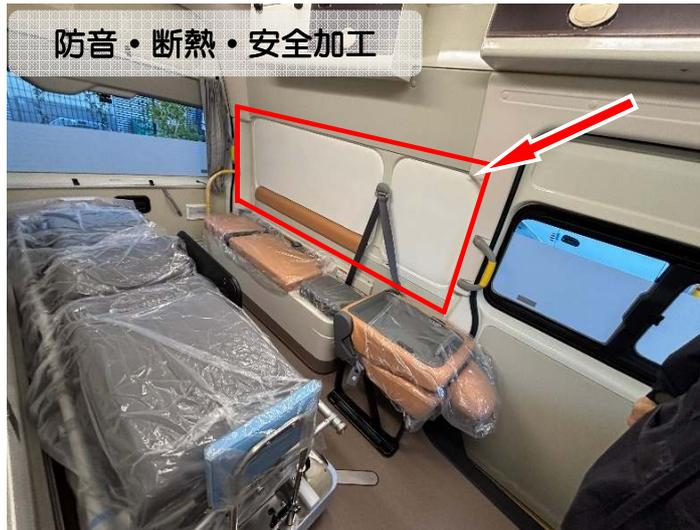
左の窓ガラス部にも**断熱・防音・安全加工**を施しています。左にも施工すると、防音効果が従来モデルより一層向上し、隊員間の意思疎通に役立ちます。
