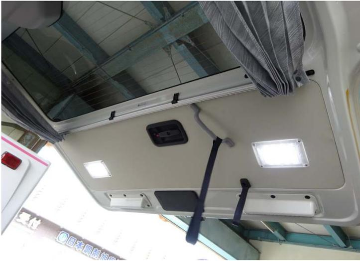
バックドア下部にLED灯を2個取付けし、
