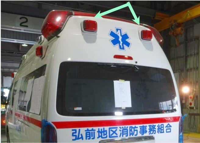
バックドア上部にLFA-160を装着することで、後方のみならず左右側方へも赤色発光をさせています。
