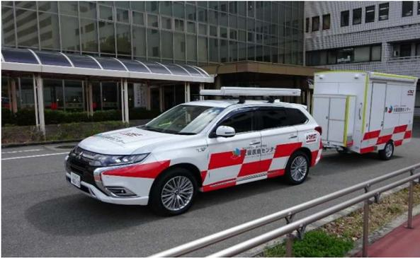
三菱自動車のアウトランダーPHEVがベースです。基本は電気自動車ですが、ガソリンエンジンも発電用に装備しておりますので、電気出力は、最大で約10日間にも及びます（使用状況に左右されます）
