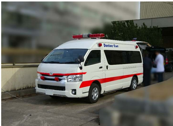
福祉車両(トヨタ・ハイース・ワイルドキャブ)からドクターカーへ改造
