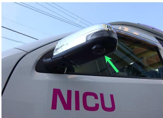
アラウンドビューモニターの側面カメラは、ドアミラー下に装着されています。
