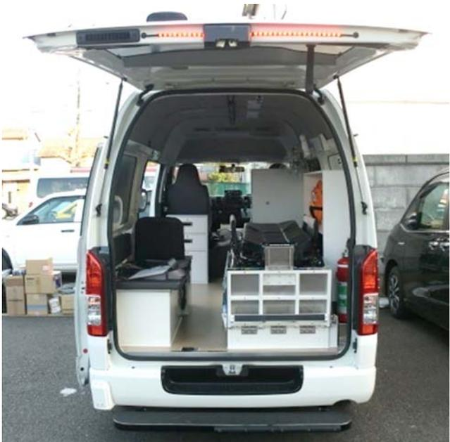
患者室内は、運転席後部資機材棚・助手席後部資機材棚（引出し仕様）・ストレッチャー用架台・1人掛け前向き座席（下部収納庫）・2人掛け横向き座席（下部収納庫）・酸素ボンベ収納（2本）・各医療器材用棚・点滴掛け、換気扇等を備えています。
