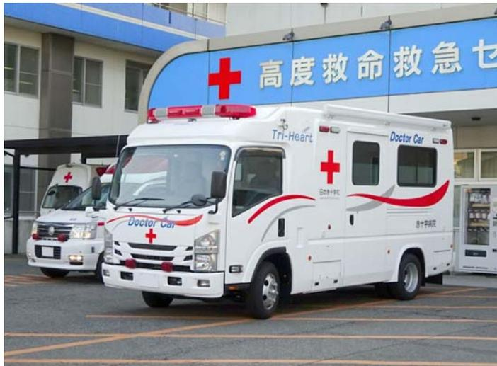
災害救護活動を考慮し、4WD車をベースにサイドタープも装備しております。ボディーは、FRP樹脂により軽量化を図り、内側には断熱材を施工することで様々な環境下での室内快適性を増しています。
