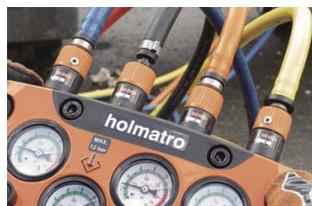
ホース離脱時の事故防止の為に、2ステップの操作でロック解除となるセーフティカバーを採用しています。
