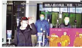
青枠内に入れば瞬時に温度表示し、設定温度を超過した場合、顔の部分赤く表示
