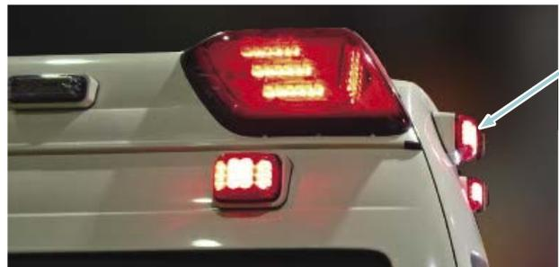
左右側方発光付きバックドア補助赤色点滅灯
