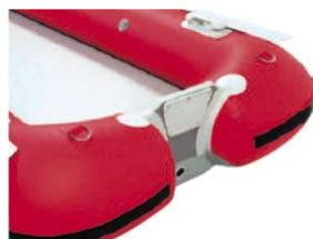
スモールトランサムにエンジンを付け、機走での移動も可能です。
