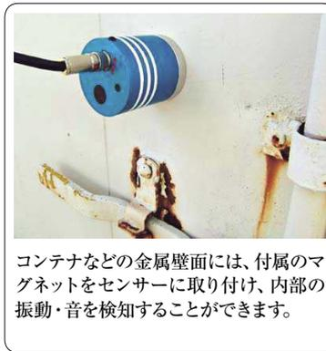
コンテナなどの金属壁面には、付属のマグネットをセンサーに取り付け、内部の振動・音を検知することができます。
