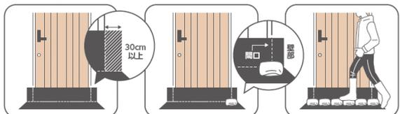
①シートを置く ②土のうを置く ③土のうを並べる ④設置完了
