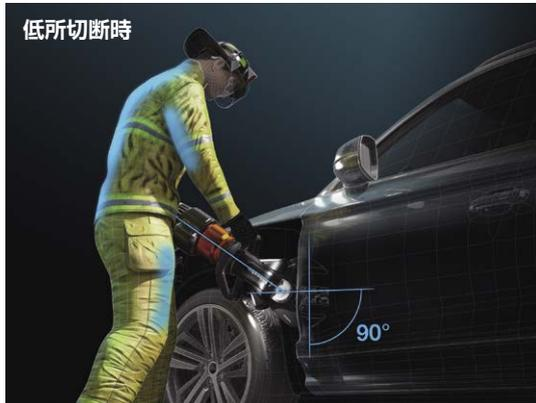
ヒンジやサイドシル等、低い部分を切断する場合でも同じ原理が適用されます。低い部分を切断する場合、背中に過度の負担をかけながら屈む必要があり、身体的に無理な体勢となります。インクラインドカッターを使用すれば、楽な体勢で低い位置でも切断できます。
