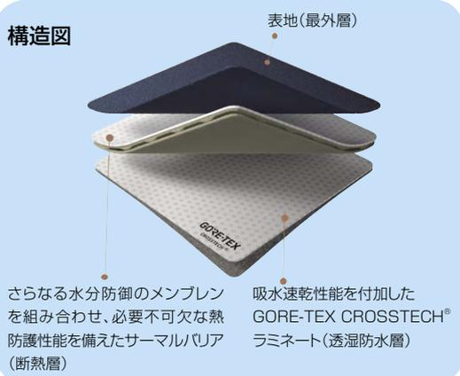
さらなる水分防御のメンブレンを組み合わせ、必要不可欠な熱防護性能を備えたサーマルバリア(断熱層)
