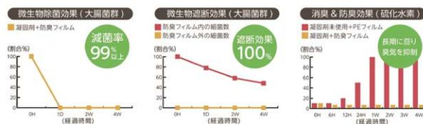
ラップ済み袋をそれぞれの条件で試験を行い、臭気漏れ・微生物(細菌)の遮断効果を確認しています。また、ラップ専用凝固剤を併せて使用することで優れた除菌効果も確認できました。
