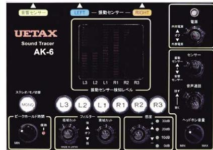
微弱な信号を増幅する入力感度切り替え機能があり、高音域、低音域をカットして雑音を下げ聴きやすくするフィルターを搭載しています。また一つのセンサーの検出音だけを集中して聴くためのセンサー選択や、ステレオ/モノラル切り替えも可能です。レベルメーターの一瞬の応答を見逃さないピークホールド時間が変更できる機能も搭載しています。
