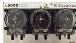
洗剤・撥水剤を自動的に計測・投入を行います。最適量の洗剤を効率よく投入することができ、経済的で手間を省力化できるシステムです。
